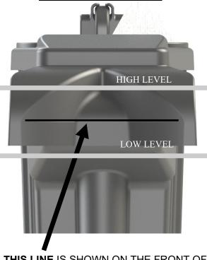
THIS LINE IS SHOWN ON THE FRONT OF THE SHROUD DEFLECTOR. IT IS THE OPTIMAL WATER LEVEL. MAINTAINING THIS LEVEL ASSURES PROPER OPERATION.
